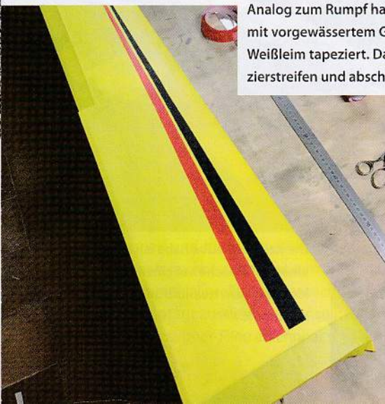
Die V-Form habe ich auf 6° abgesenkt, leicht aufgestellte Flügelohren geschnitten und Querruder vom Flügel abgetrennt. Die Stirnseiten von Fläche und Querruder sind verkastet.
