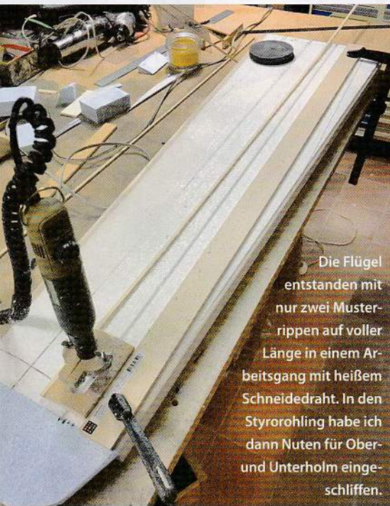
Mit einem scharfen Messer habe ich die Servobox in den Flügel gegraben, der Kabelkanal ist ins Styropor eingefräst.
