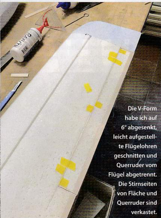
Analog zum Rumpf habe ich den Flügel mit vorgewässertem Geschenkpapier und Weißbleim tapeziert. Dazu kamen Papierzierstreifen und abschließend Parkettlack.
