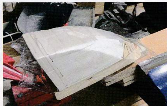
Die Kabinenhaube habe ich aus einer PET-Flasche auf einem Formklotz mit dem Heißluftföhn geschrumpft.
