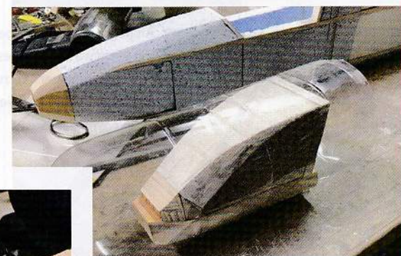
Die Kabinenhaube habe ich aus einer PET-Flasche auf einem Formklotz mit dem Heißluftföhn geschrumpft.
